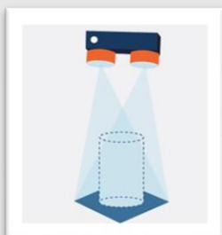
Nach vollständiger Trocknung von AESUB orange kann das Objekt, wie gewohnt, gescannt werden.
