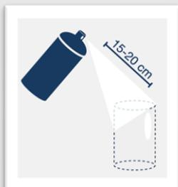
Tragen Sie AESUB orange aus einem Abstand von 15-20 cm auf. Besprühen Sie die komplette Oberfläche, die gescannt werden soll.
