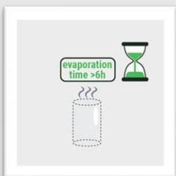
Die aufgetragene Schicht von AESUB green verflüchtigt selbstständig nach dem Scannen. Die sonst aufwendige Reinigung nach der Anwendung entfällt.
