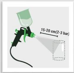
Tragen Sie AESUB green aus einem Abstand von 15-20 cm auf mit einer Sprühpistole auf. Hier empfehlen wir entweder die Akkubetriebene AESUB spray gun (AESSG001) oder Sprühpistolen mit einem Düsendurchmesser ab 1mm. Besprühen Sie die komplette Oberfläche, die gescannt werden soll. Sprühen Sie gleichmäßig, mit der Düse auf das Objekt gerichtet, langsam hin und her, um eine gleichmäßige Beschichtung zu erhalten.
